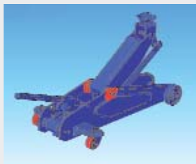
Nessa ilustração as regiões em vermelho indicam falhas em potencial.
